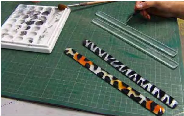
Bemalen der Glasstäbe per Hand passend zum Motiv. Painting the glass rods by hand to match the image. Peindre les baguettes de verre à la main en fonction du visuel.
