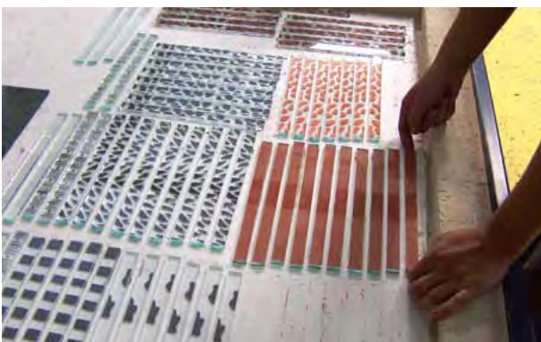
Bemalte oder mit Metall gemischte Glasstäbe nach dem Brennen. Glass rods, painted or metal-mixed after firing. Baguettes de verre peintes ou en métal après la gravure.
